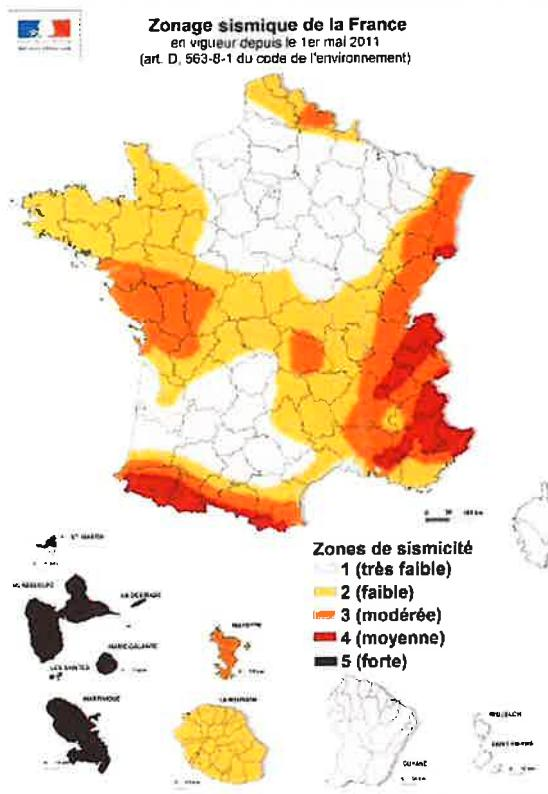
Les données de sismicité instrumentale et historique et des calculs de probabilité permettent d'aboutir à l'élaboration d'un zonage sismique. Cette analyse probabiliste représente la possibilité pour un lieu donné, d'être exposé à des secousses telluriques.
